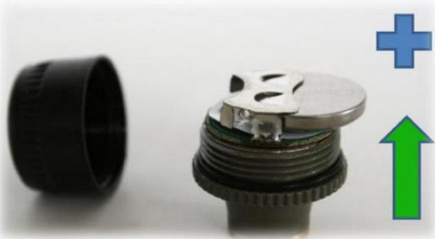
Le couvercle doit être serré à la main de manière à rester imperméable à l'eau. S'il vous plaît, NE PAS utiliser des pinces et une clé à pipe! Un serrage excessif peut endommager les joints toriques.
